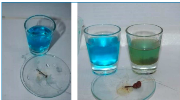
Figura 3. A la izquierda se muestran el clavo de hierro y disolución de sulfato de cobre (II), a la derecha lo que queda del clavo 24 horas más tarde y se compara con una disolución idéntica a la inicial. Se observa el cobre depositado y el cambio del color de la disolución
