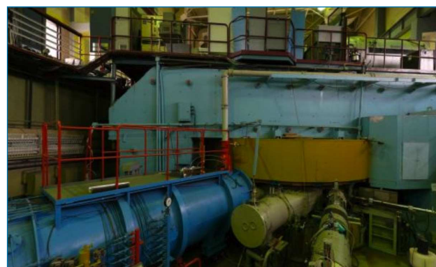
Figura 2. Ciclotrón U400 del JINR donde se aceleraron iones de 48 Ca, isótopo poco abundante del Ca, con energías de 251 MeV. El blanco estaba formado por óxidos de 249 Cf depositados en láminas de Ti de 1,5 μm de espesor [4]
