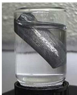
Figura 1. Litio metálico flotando en aceite [3]
