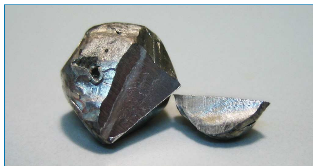
Figura 1. Pieza de indio recién cortada. Se observan el brillo metálico y las marcas de los instrumentos empleados para el corte, indicativas de la ductilidad del metal
