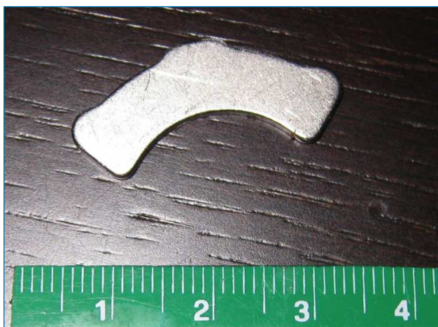
Figura 1. Imán de neodimio extraído de un disco duro averiado del autor. Con estos dispositivos, sin duda, se ha perdido más información que con el incendio de la Biblioteca de Alejandría
