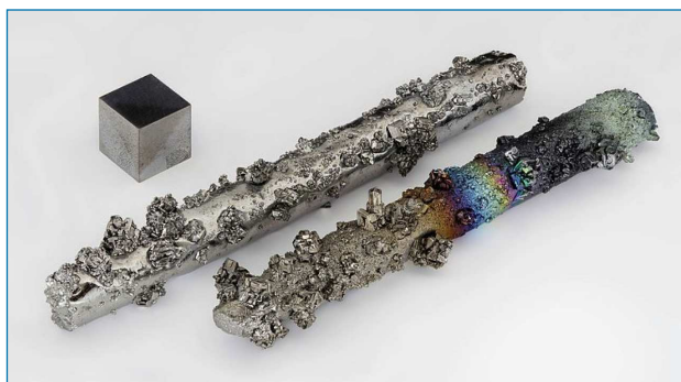
Figura 1. Varillas de wolframio con cristales evaporados, parcialmente oxidadas (pureza 99,98 %) y cubo de wolframio de 1 cm 3 de alta pureza (99,999 %) para su comparación [5]
