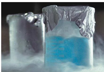
Figura 1. Oxígeno líquido en un vaso de precipitados (Consulta en: https://bit.ly/2RusrEZ , visitada el 1 de febrero de 2019)
