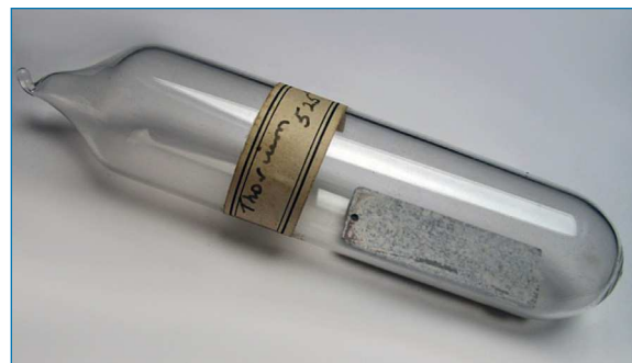
Figura 1. Metal torio mostrando signos de corrosión
