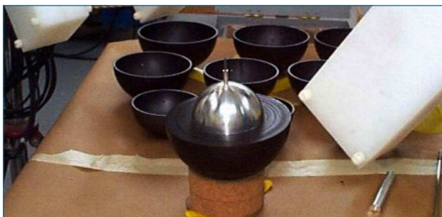
Figura 1. Esfera de neptunio revestida de níquel [3]
