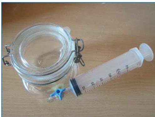
Figura 22. Frasco provisto de llave de tres vías con una jeringa conectada a la llave
