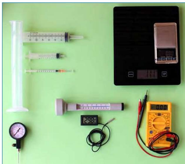
Figura 1. Instrumental de bajo coste. De arriba hacia abajo y de izquierda a derecha: probeta y jeringas, manómetro para balones, diferentes tipos de termómetros (analógico y digital con sonda de temperatura), balanzas de distinto rango de medida y sensibilidad y polímetro
