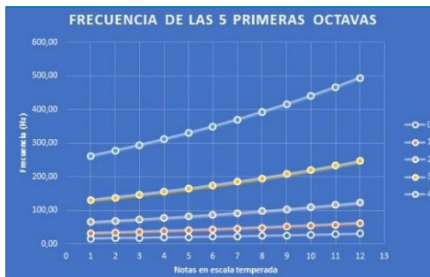
Figura 6. Frecuencia de las notas de las primeras octavas de la escala temperada. Se aprecia la no linealidad en la progresión de frecuencias
