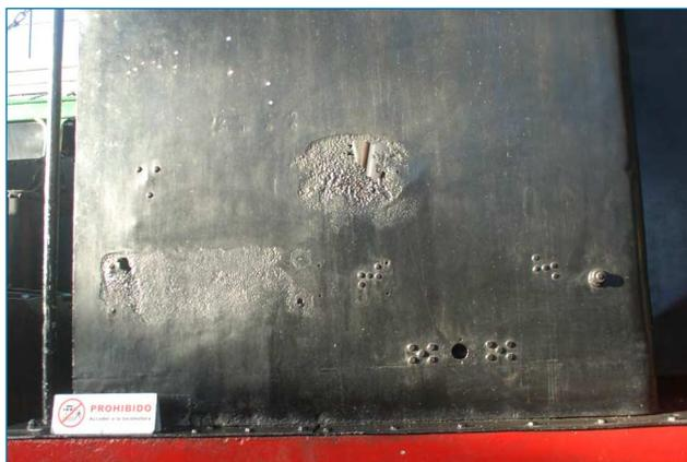
**Figura 14.** En los lugares de esta locomotora 240 “Mastodonte” se aprecia que donde se ubicaban placas de bronce se ha producido una intensa corrosión que ha atravesado la pared de la cabina. También se aprecia en las zonas en que se acumula humedad.
