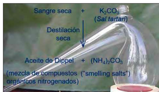
Esquema 3. Obtención del aceite de Dippel
