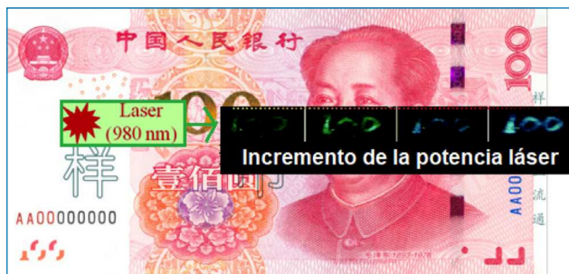
Figura 13. Billeto de 100 yuan o remimbi, impreso en zonas estratégicas con tintas de conversión ascendente de fotones ( upconversion ), capaces de emitir radiación bajo excitación infrarroja
