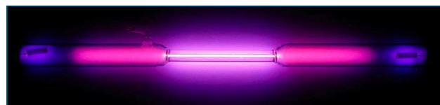
Figura 2. Tubo de descarga relleno de argón. https://pse-mendelejew.de/argon/
