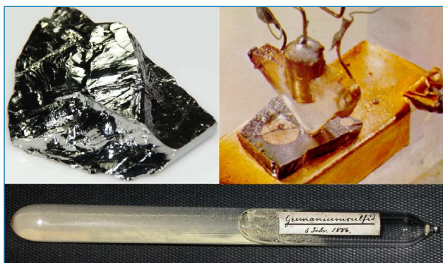
Figura 1. Primera precipitación de sulfuro de germanio (debajo), pedazo de germanio elemental (izquierda) y primer transistor fabricado por los Laboratorios Bell con un bloque de germanio policristalino ultra puro (derecha) [2]
