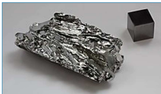
Figura 1. Fragmento macrocristalino de molibdeno (pureza 99,99 %) junto a un cubo monocristal de 1 cm 3 de molibdeno de alta pureza (99,999 %) [1]
