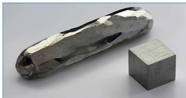
Figura 1. Una barra de cristal de cadmio (pureza 99,999 %) obtenida por el proceso de flujo y un cubo de 1 cm<sup>3</sup> de cadmio<sup>[1]</sup>
