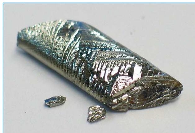
Figura 1. Cristal de telurio ultrapuro (longitud *ca.* 2 cm)<sup>[5]</sup>
