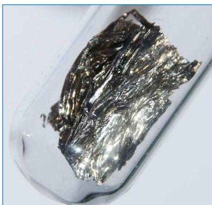
Figura 1. Muestra de samario metálico conservada en atmósfera inerte en una ampolla de vidrio<sup>[3]</sup>
