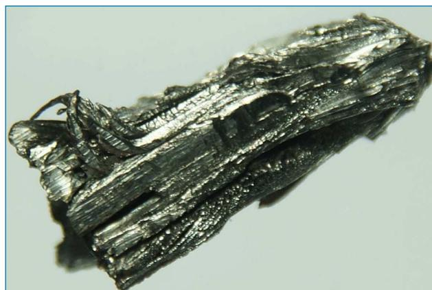
Figura 1. Disprosio dendrítico ultrapurificado<sup>[4]</sup>
