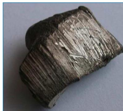
Figura 1. Iterbio metálico<sup>[2]</sup>
