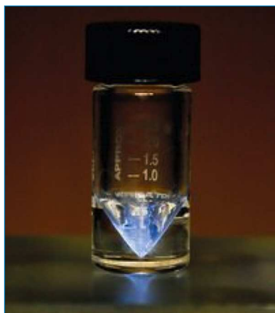
Figura 1. Disolución acuosa de una sal del catión trivalente de 225 Ac mostrando luminiscencia de Cherenkov [2]
