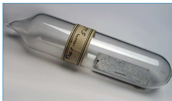
Figura 1. Metal torio mostrando signos de corrosión
