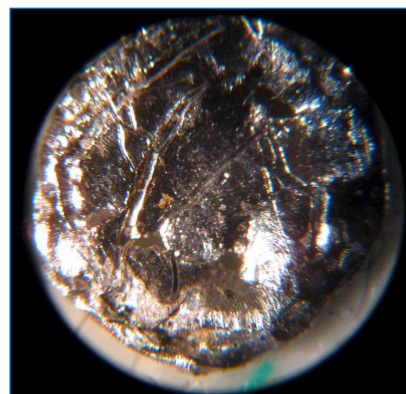
Figura 1. Pequeño disco de americio bajo el microscopio [4]
