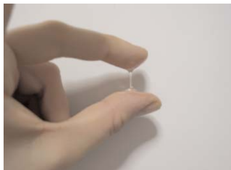
Figura 6: Detección visual de que el proceso de inversión de la sacarosa ha comenzado.
