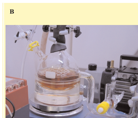
Figura 1. a) Esquema del equipo utilizado por S. L. Miller, en 1953, en su primer experimento de síntesis de aminoácidos en las supuestas condiciones prebióticas de la Tierra primitiva. b) Disolución rojiza obtenida tras una semana de descargas eléctricas sobre una mezcla de gases ( \text{CH}_4 + \text{NH}_3 + \text{H}_2 + \text{H}_2\text{O} ) en condiciones similares a las utilizadas por S. L. Miller en 1953.
