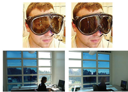
Figura 5. ( superior ) Dispositivo electrocrómico flexible de transmisión variable integrado en un sistema de visión desarrollado por los grupos del Pr. G.A. Sotzing (Institute of Materials Science, UCONN) y Pr. T.F. Otero (Centro de Electroquímica y Materiales Inteligentes, UPCT) ( inferior ) Ventana inteligente desarrollada por la compañía SAGE.
