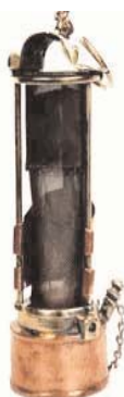
Ilustración 3. La lámpara de seguridad ideada por Davy; en ella la malla de un tejido metálico impide que la llama se propague.
