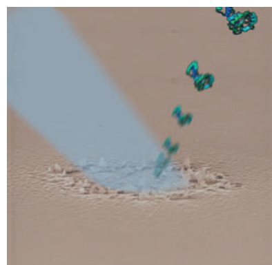
Figura 6. Ilustración en la que se muestra una imagen de la superficie empleada en la técnica NIMS, y la correspondiente desintegración de la misma tras irradiación láser.
