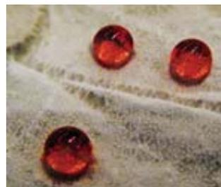
Figura 2. Fotografía que muestra gotas de octano coloreadas sobre una superficie oleofóbica depositada sobre una hoja de loto.
