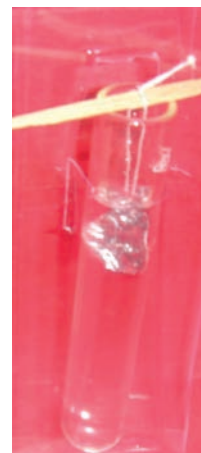
Figura 5. Formación de un árbol metálico.
