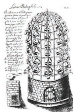
Figura 5. Torre de Mattioli, que permitía destilar grandes volúmenes de agua.
