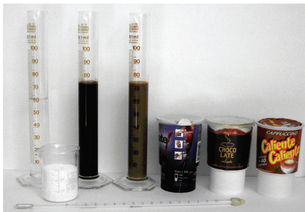
Figura 3. Probetas con el agua (izquierda), chocolate (probeta central) y café con leche contenidos en vasos "autocalentables"; vaso de precipitados con el cloruro cálcico contenido en un vaso de bebida; termómetro empleado y tres envases de bebidas.
