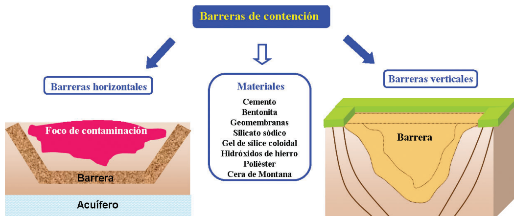
Figura 6. Disposición de las barreras de contención.
