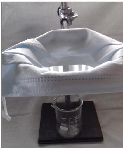
**Figura 15.** Comprobación de la impermeabilidad de una mascarilla
