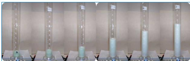
**Figura 4.** Volumen de espuma formado en función de los moles de HAC, con 2,0 ml de lavavajillas al 50%, a los 60 s de añadir 0,8 g de  $\text{NaHCO}_3$  con velocidad 2 del agitador magnético a temperatura ambiente ( $18^\circ\text{C}$ )
