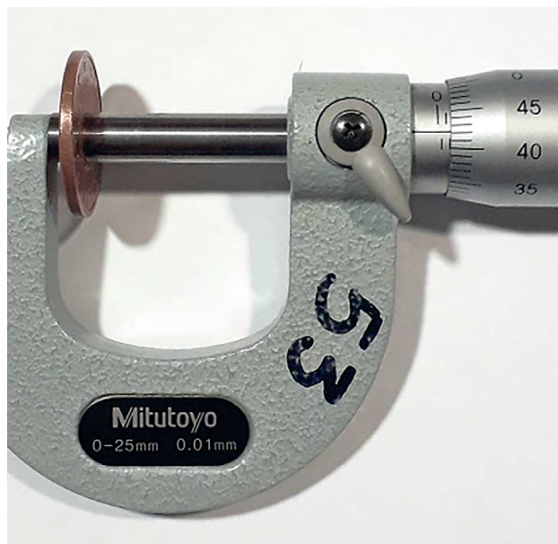
Figura 3. Medida del espesor interior de la moneda con un micrómetro.
