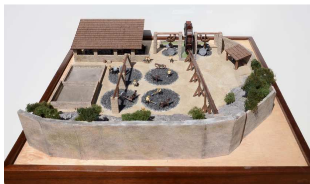
Figura 13. Método de patio de Bartolomé de Medina (Maqueta realizada por Marco Hernández. Archivo Histórico y Museo de Minería, A.C. Pachuca, México)
