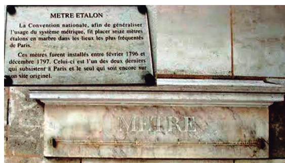
Figura 1. Patrón del metro fabricado en mármol, ubicado en un muro de París desde finales del siglo XVIII.
