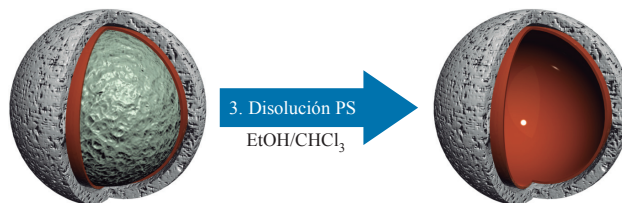
Figura 8. Eliminación del soporte de poliestireno para obtener una cápsula híbrida hueca.
