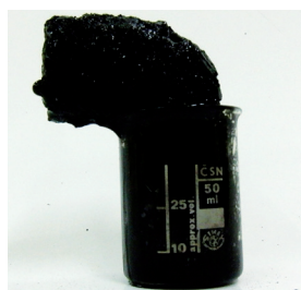
Figura 7. Deshidratación del azúcar por efecto del ácido sulfúrico.
