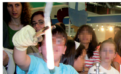
Figura 4. Efecto comburente del clorato de potasio con azúcar.
