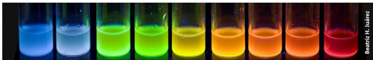
**Figura 1.** Viales conteniendo dispersiones coloidales de nanocristales de CdSe en medio líquido, de tamaño creciente (de izquierda a derecha), desde un tamaño medio de 2 nm hasta un tamaño medio de 5 nm, obtenidos mediante una síntesis por inyección en caliente y excitados ópticamente con una lámpara UV.
