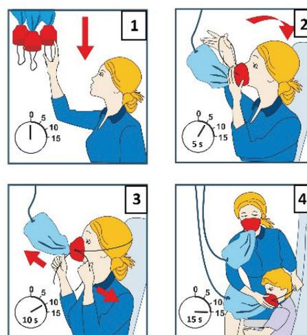
Figura 3. Instrucciones para colocarse las máscaras de emergencia.
