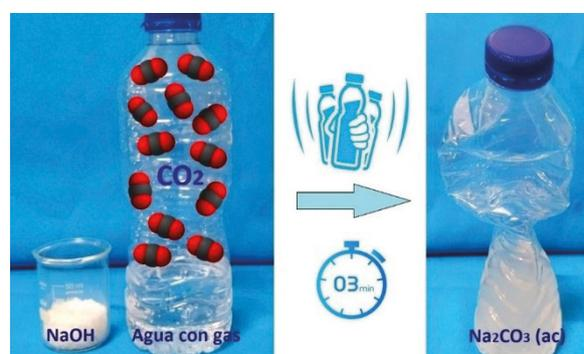
Figura 8. Efecto de la captura del CO<sub>2</sub> desprendido por un agua mineral con gas.
