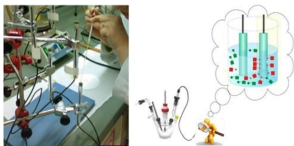
Figura 6. Preparación de los sensores potenciométricos en el IC-MAB-CSIC con el esquema de su funcionamiento.
