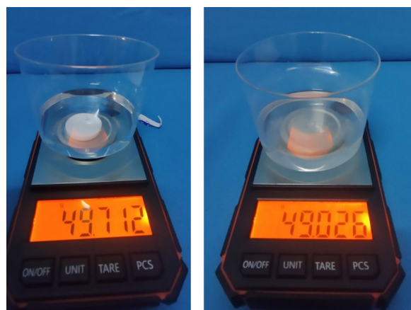
Figura 5. Variación de la masa al disolverse la tableta efervescente.
