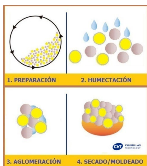
Figura 1. Etapas del proceso de granulación por vía húmeda (figura extraída de la ref. [4]).
