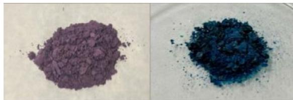
**Figura 5.** Muestras de los sólidos de los complejos de vanadio sintetizados. Izquierda:  $(\text{NH}_4)_2[\text{VO}(\text{tart})] \cdot \text{H}_2\text{O}$ . Derecha:  $[\text{VO}(\text{acac})_2]$ .
