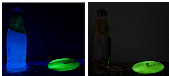
Figura 18. Tónica y objeto con pintura fosforescente bajo luz UV (izquierda). Tónica y objeto con pintura fosforescente después de haber sido irradiados con luz UV (derecha).
