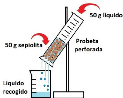
Figura 5. Esquema del montaje para determinar la capacidad de adsorción de la sepiolita.
